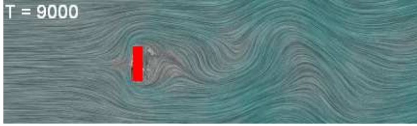
Rysunek B.2: Wizualizacja pól prędkości płynu FHP-III za pomocą algorytmu LIC. Rozmiar układu wynosi 3056 \times 1024LU , rozmiar przeszkody 96 \times 288LU średnia gęstość \rho = 1.32 , gradient ciśnienia \Delta p / \Delta x = 1.1 \cdot 10^{-4} , długość krzywej całkowania L = 30 . Dane do rysunków pobrano w 3000, 6000, i 9000 kroku symulacji.
